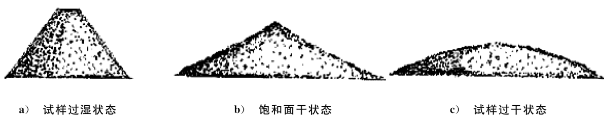
图4 天然砂饱和面干状态示意图
